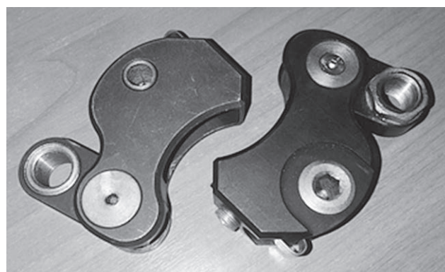
Рисунок 1 – Специальное тренажерное устройство для оптимизации техники педалирования (Патент №2543444 от 27.02.2015 г.)
