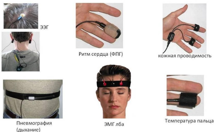
Рисунок 1 – Крепление электродов и датчиков для регистрации физиологических показателей при проведении сеансов с биологической обратной связью
