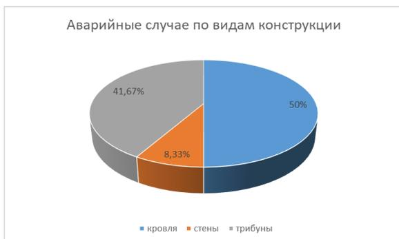
Рисунок 1 - Распределение аварийных случаев по видам конструкции
