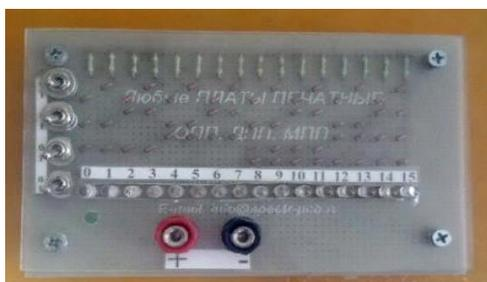
Рисунок 2 - Декодер, применяемый в рамках лабораторной работы
