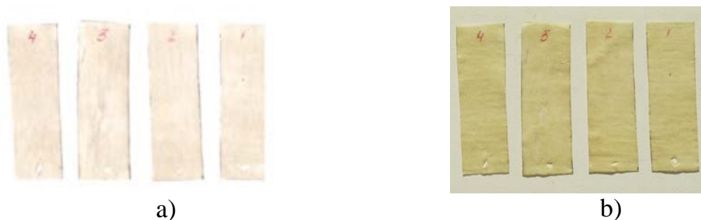
Рисунок 1 – Свободные пленки до (а) и после (б) экспонирования в модельной среде
