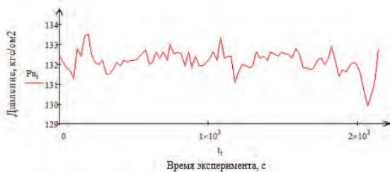
Рисунок 3 – Изменение давления на выходе из котла
