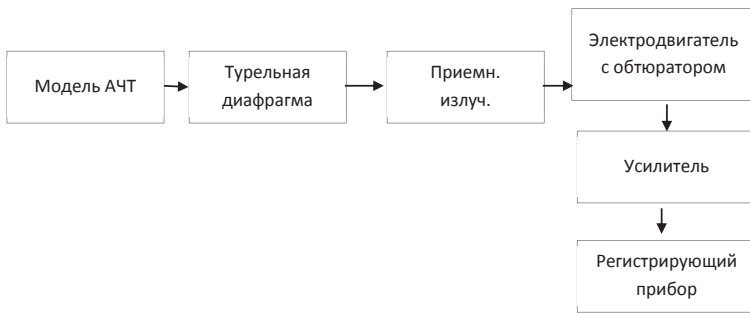
Рисунок 1 – Схема установки для определения интегральной чувствительности ИК – приемника
