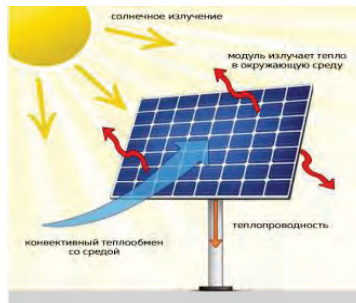
Рис. 1. Теплообмен в солнечной панели[1]
