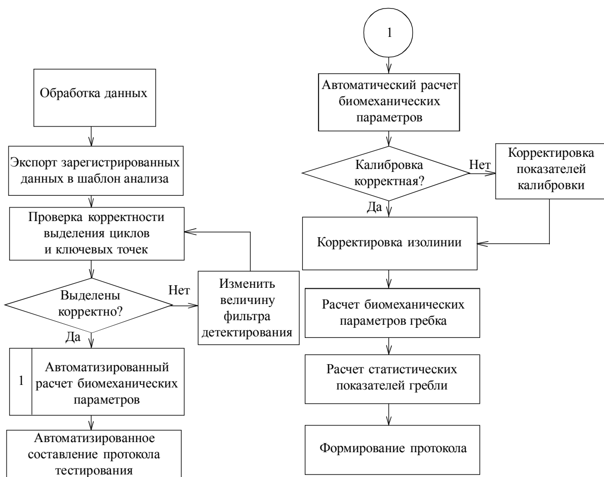
Рис. 3. Алгоритм программной части АПК
