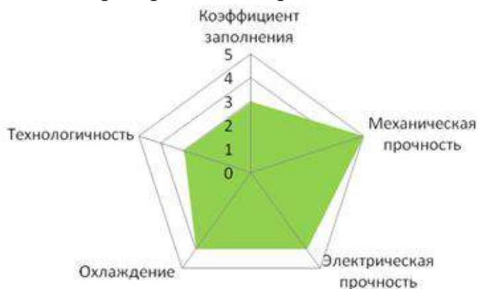
Рисунок 3 – Качественные критерии цилиндрической многослойной обмотки
