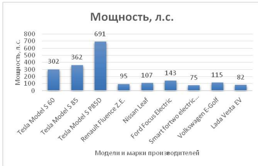
Рисунок 3. Сравнение мощности электродвигателей
