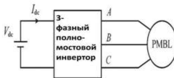
Рисунок 1 - Схема бесщеточного электродвигателя на постоянных магнитах
