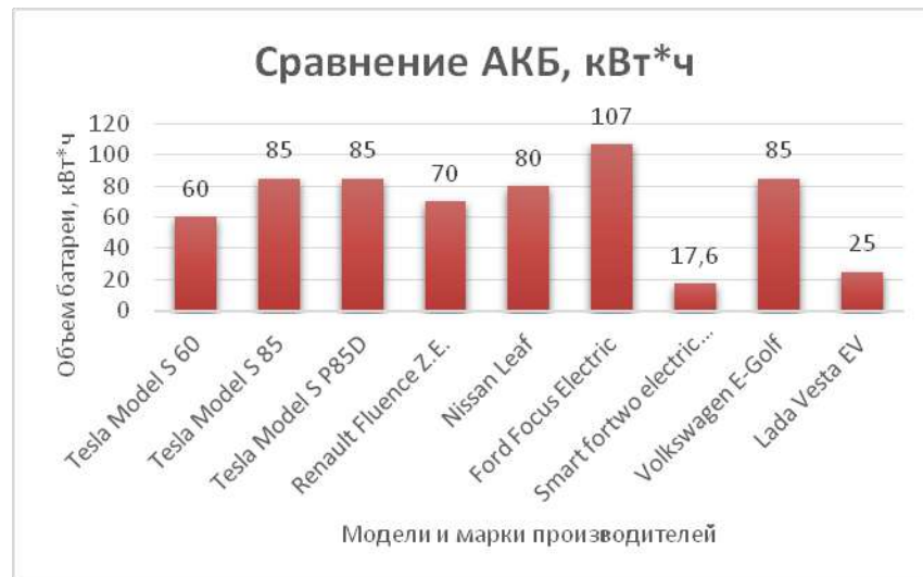
Рисунок 4. Сравнение объема батареи электромобилей
