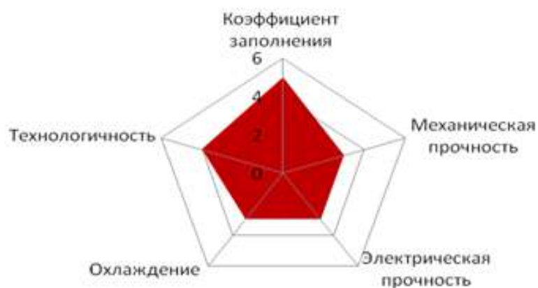
Рисунок 2 – Качественные критерии цилиндрической однослойной обмотки
