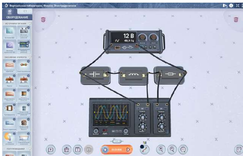
Рис. 2. Установка для исследования последовательной RLC-цепи в виртуальной лаборатории МЭШ
